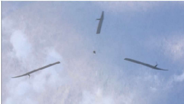
Les moteurs situés au bout des ailes de l'Héliblade permettent d'enclencher une rotation et de faire voler l'appareil. © X721
